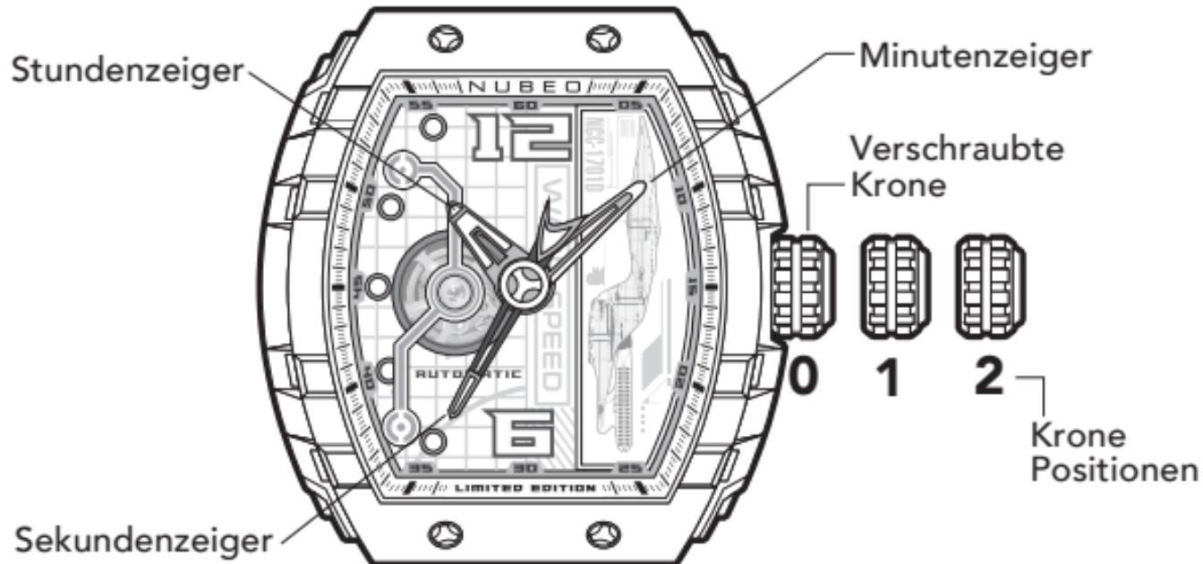
Wie Ihre Uhr über eine verschraubte Krone verfügt, lösen Sie die verschraubte Position.
